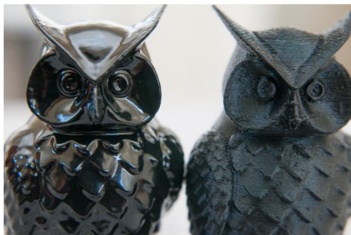
Рисунок 3 – Результат обработки модели из ABS-пластика парами ацетона
