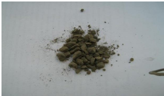
Рисунок 2 – Добавка на основе природного асфальта (Тринидад – асфальт)
