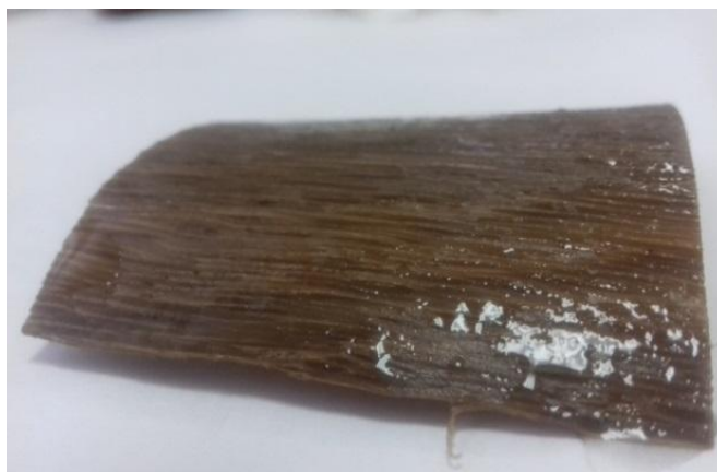
Рисунок 6 – Вид образца дубового шпона, пропитанного раствором (поверхность покрыта тонким слоем воды)
