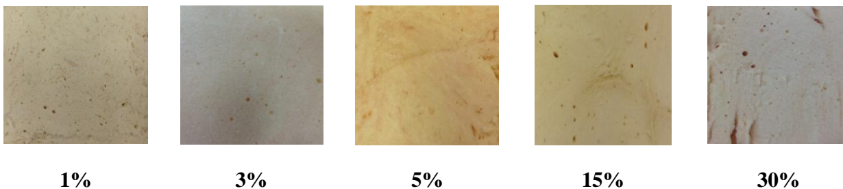
Рисунок 5 – Образцы ППУ, наполненные стеклосферами
