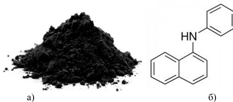
Рисунок 1 – а) Газовая сажа; б) Структура N-Фенил-2-нафтиламина
