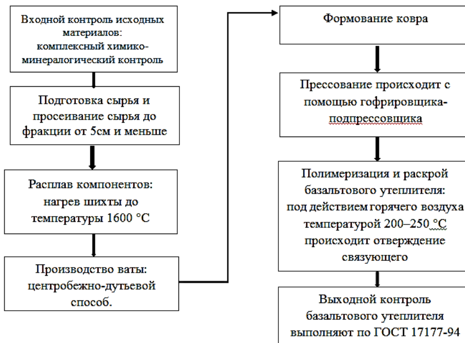
Рисунок 3 – Технологическая схема изготовления базальтового утеплителя
