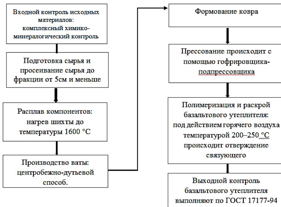
Рисунок 3 – Технологическая схема изготовления базальтового утеплителя
