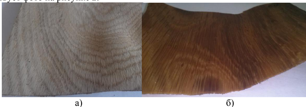
Рисунок 2 – Вид образца дубового шпона а) до и б) после проведения испытаний на водопоглощение
