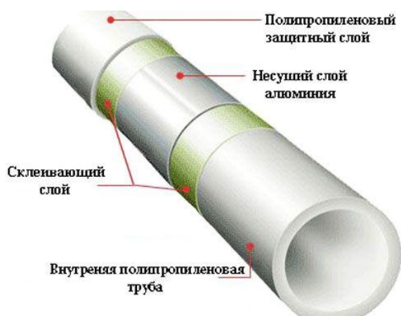
Рисунок 1 – Структура полипропиленовой трубы
