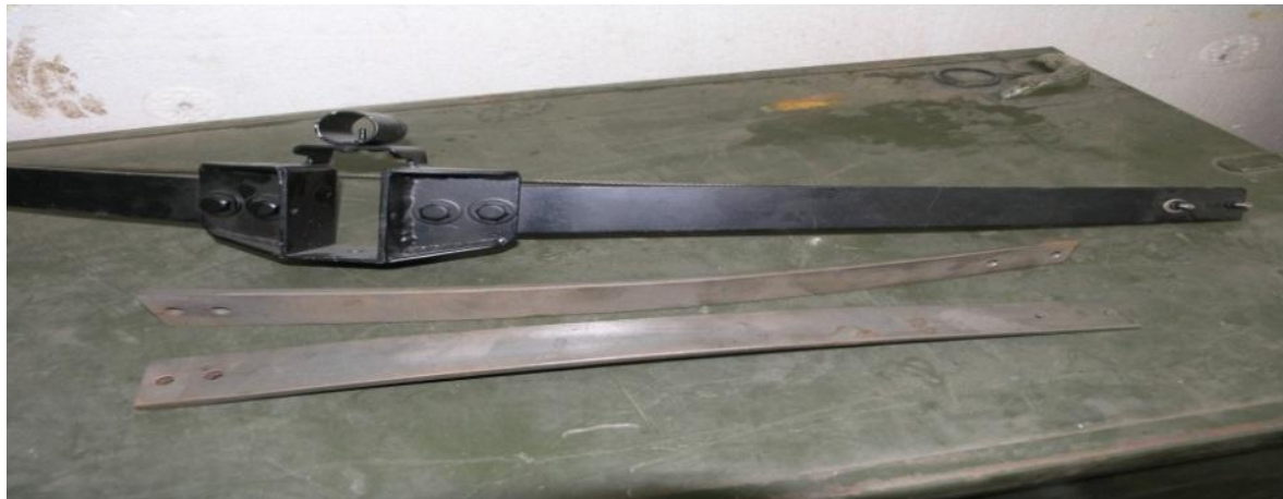
Рисунок 2 – Плечо, изготовленное из конструкционной стали 60С2.
