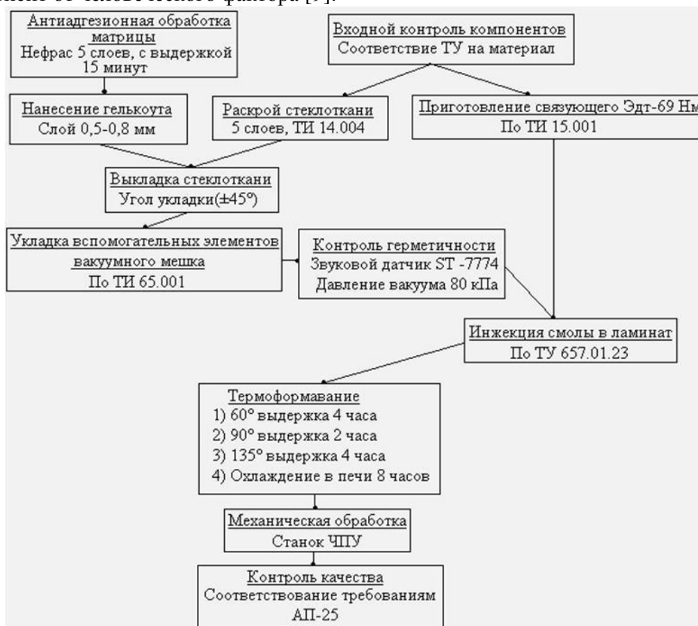
Рисунок 2 – Технологическая схема процесса инфузии
