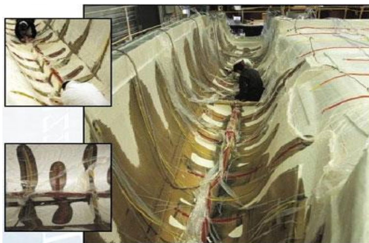
Рисунок 2 – Процесс вакуумной инфузии
