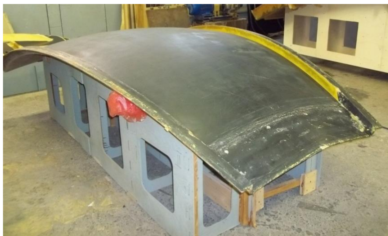
Рисунок 1 – Оснастка из стеклопластика
