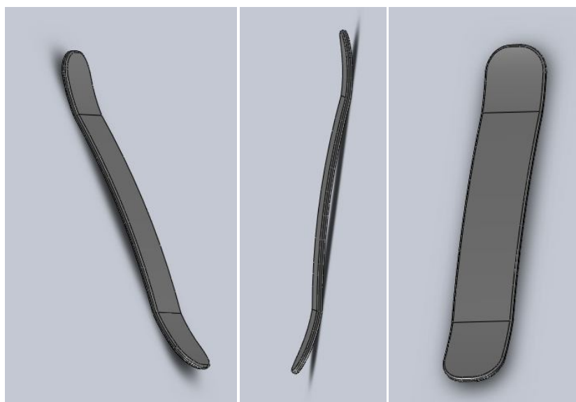
Рисунок 1 – Модель сердцевины сноуборда.
