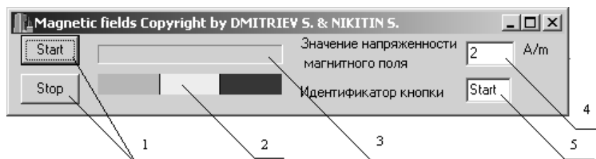
Рис. 3. Интерфейс программы: 1 – кнопки управления, 2 – графическое обозначение уровней опасности; 3 – уровень напряженности; 4 – значение напряженности; 5 – идентификация нажатия кнопки
