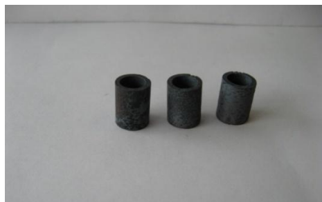
Рисунок 6 - Образцы с боридным покрытием после испытаний.
