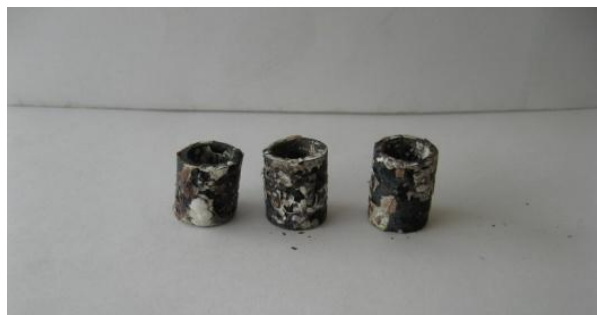
Рисунок 4 - Образцы с покрытием на основе оксида цинка после испытаний.
