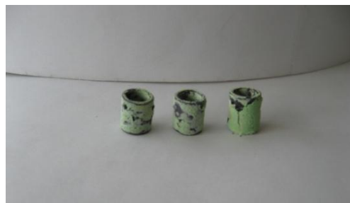
Рисунок 7 - Образцы с фосфатным покрытием после испытаний.
