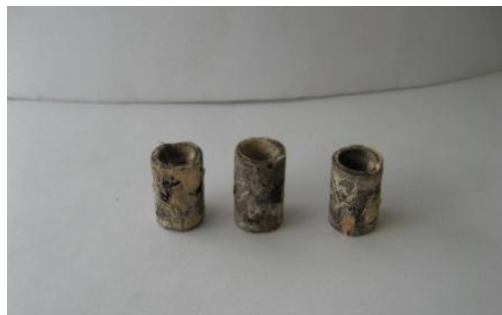
Рисунок 5 - Образцы с покрытием на основе оксида цинка и асбеста после испытаний.
