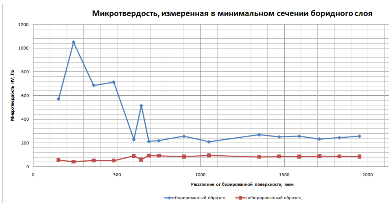
Рисунок 7 - Микротвердость после заливки
