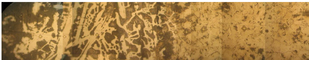
Рисунок 6 - Совмещенный снимок полученного борированного слоя
