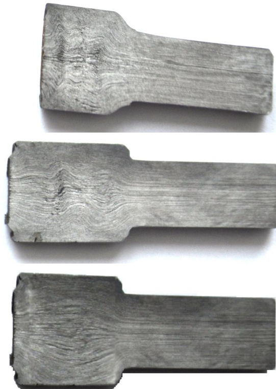
Рисунок 4 – Макрошлифы поковок корпуса распылителя полученные в результате эксперимента: а – при \sigma_{en} < \sigma_{em} ; б – при \sigma_{en} > \sigma_{em} ; в – при \sigma_{en} = \sigma_{em}
