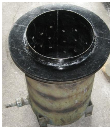
Рисунок 7- Установка для заливки форм при разряжении
