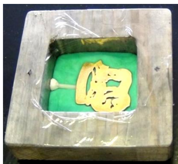
Рисунок 2 - После удаления фальшивой подмодельной плиты
