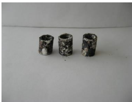
Рисунок 2 - Образцы с покрытием на основе оксида цинка после испытаний
