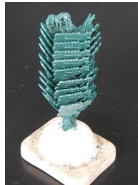
Рисунок 5 - Модельный блок, закрепленный в модели литниковой чаши
