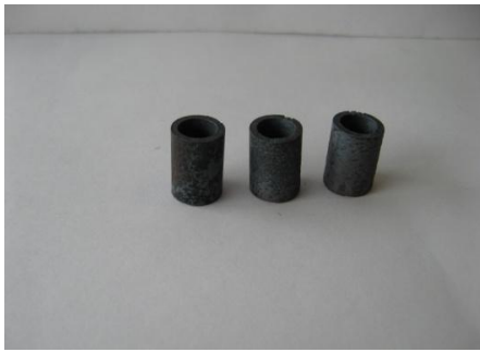
Рисунок 4 - Образцы с боридным покрытием после испытаний
