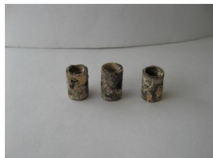
Рисунок 3 - Образцы с покрытием на основе оксида цинка и асбеста после испытаний
