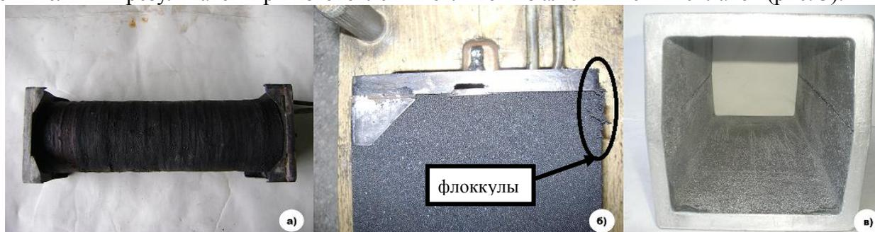
Рисунок 3 – фотографии НУ (а), стержня с флоккулами и без флоккул (б) и отливки (в)
