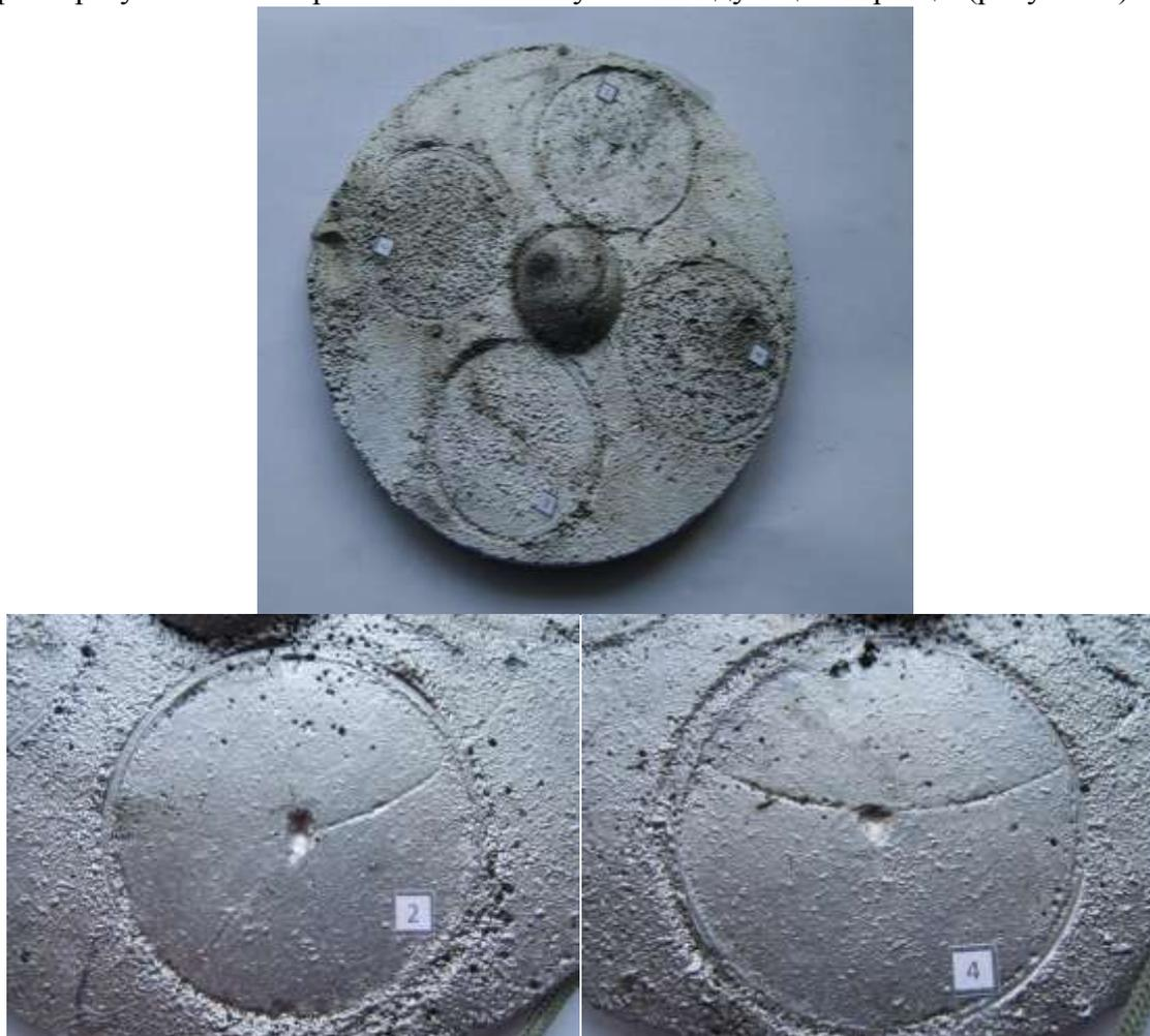
Рисунок 3 – Образцы отливок, полученные на специальной технологической пробе для определения вероятности образования пригара [2], [3]
