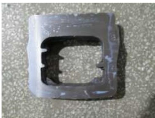
Рисунок 1– металлографический шлиф с фрагмента рамы боковой тележки во всю толщину стенки
