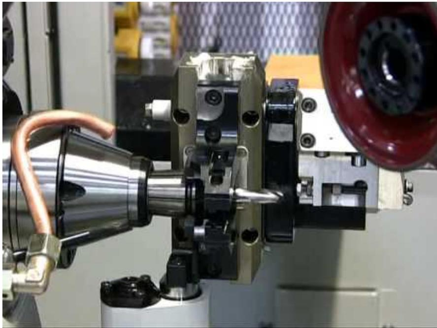
Рисунок 1 – Процесс изготовления зенкера
