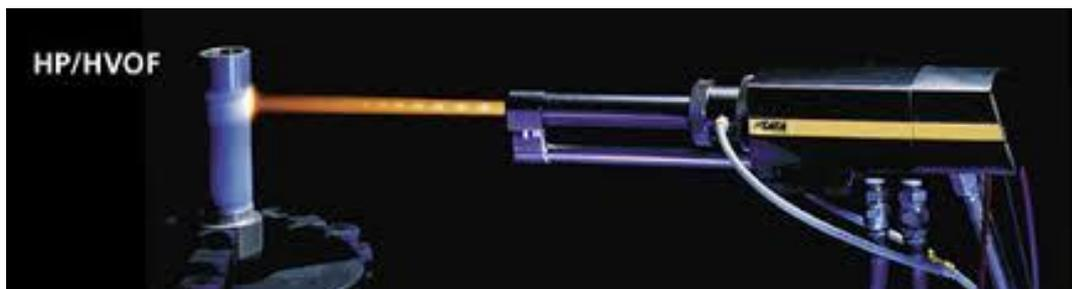
Рисунок 1 - Модель 5220 пистолета фирмы «Praxair» (США)
