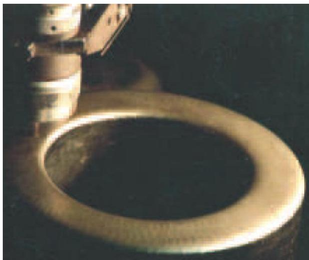
Рисунок 2 – наплавленное кобальтовым стеллитом седло задвижки DN200
