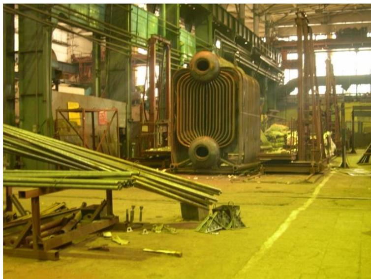
Рисунок 1 – Общий вид котлоагрегата с низкотемпературной топкой с «кипящим слоем» типа КВ-Ф-10-115-НТКС
