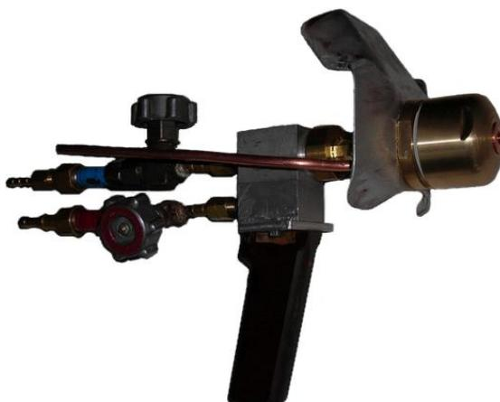
Рисунок 2 – Пистолет для СГП-наплавки
