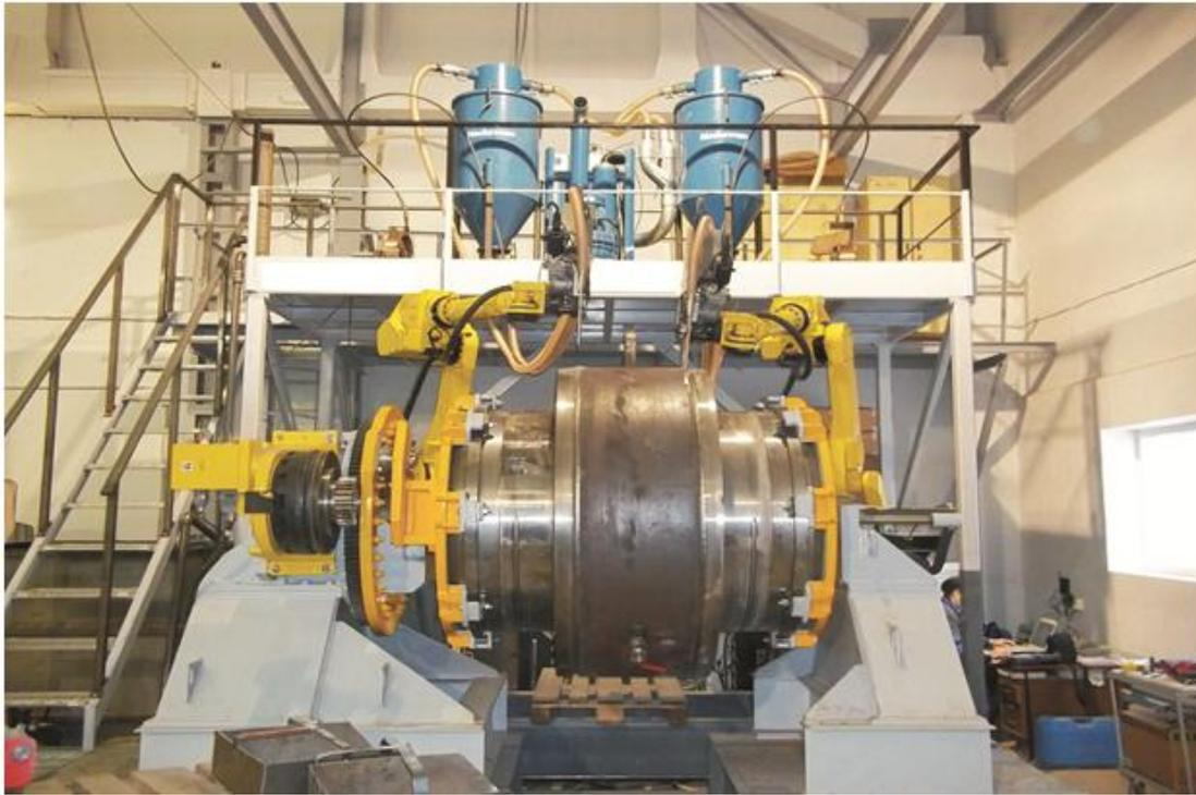
Рисунок 1 – Робототехнический комплекс для синхронной сварки под флюсом двумя роботами заключительных швов шаровых кранов DN 1000...1400, PN 12.0 МПа.
