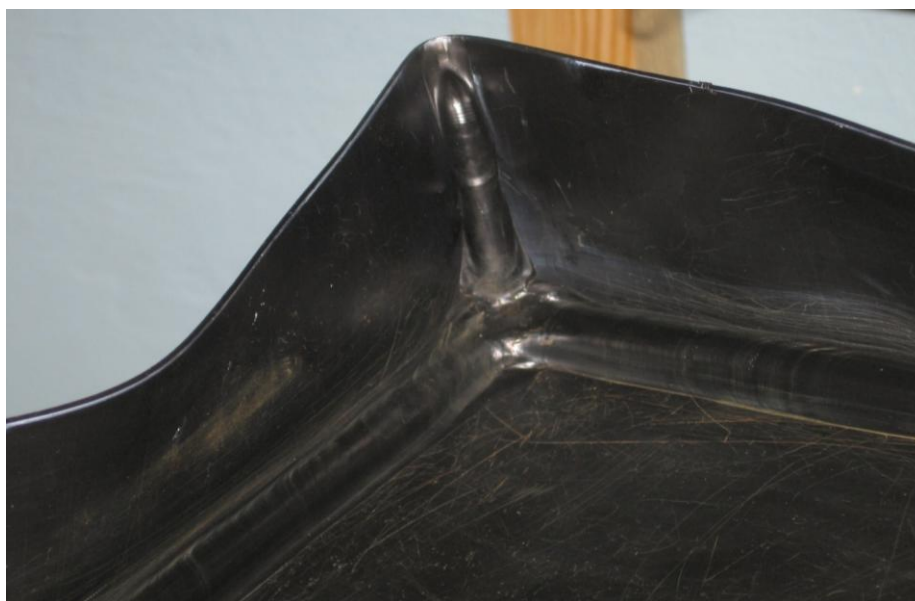
Рисунок 1 – Отработка последовательности выполнения сварных швов
