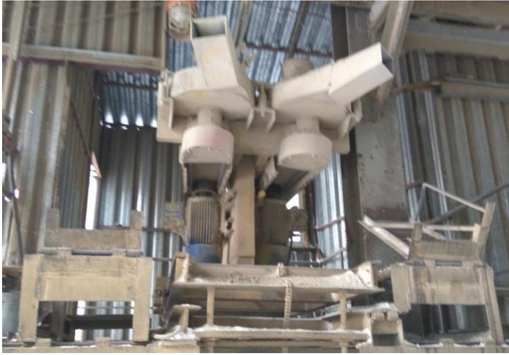
Рисунок 2 – Устройство для боковой погрузки
