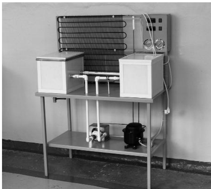
Рисунок 3 – Лабораторная холодильная установка с косвенной системой охлаждения
