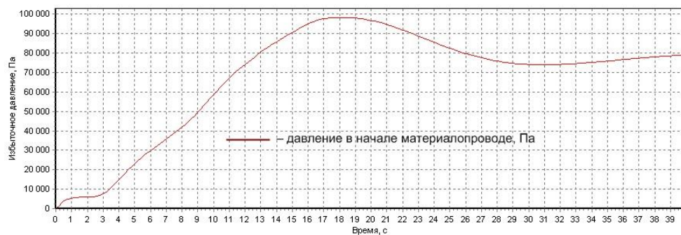
а – установка с воздухопроводом 50м
