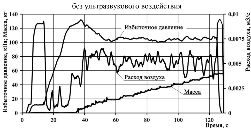
Рисунок 2 – Диаграммы изменения параметров пневмотранспортирования при ультразвуковом воздействии
