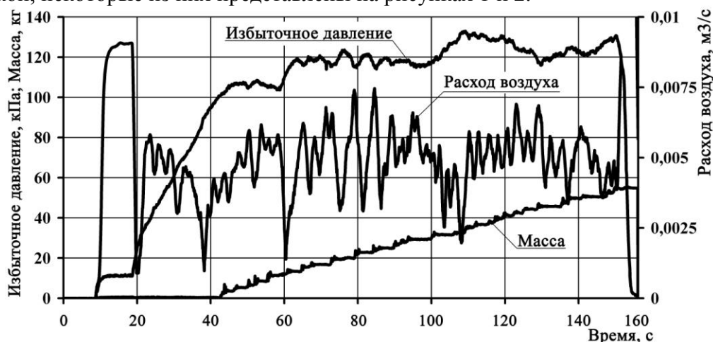
Рисунок 1 – Диаграммы изменения параметров пневмотранспортирования
