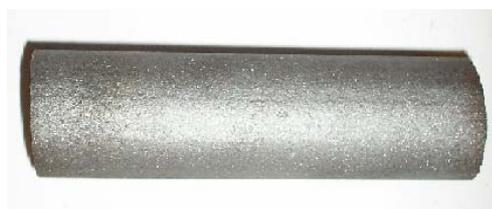
Рисунок 1- Поверхность образца после пескоструйной обработки
