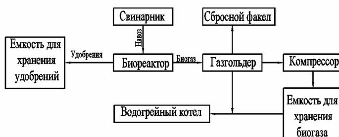
Рисунок 1 – Схема установки
