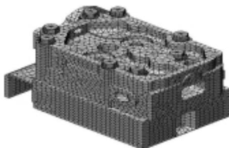
Рис.1 Модель газового стыка с наложением конечно-элементной сетки.
