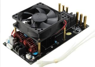
Рисунок 2 – Индукционный нагреватель
