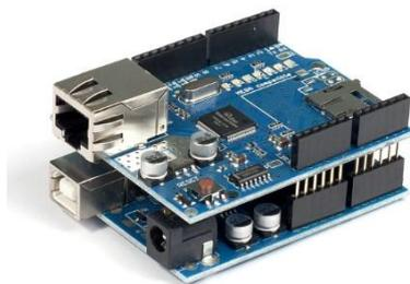
Рисунок12 – Плата Arduino и Ethernet shield
