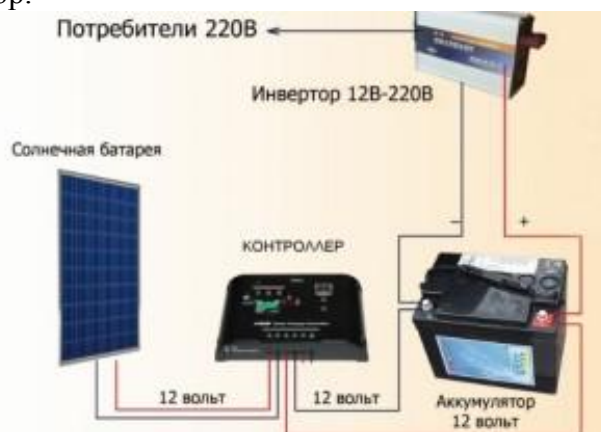
Рисунок 2 – Схема солнечной электростанции
