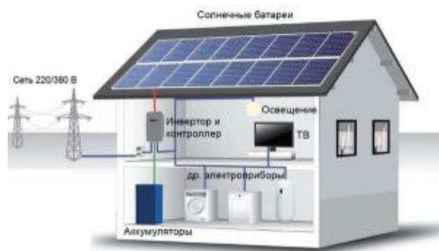
Рисунок 1 – Солнечная электростанция на фотоэлектрических модулях
