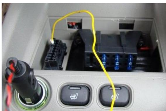
Рисунок 2 – Расположение диагностического разъема в автомобиле Lada Kalina
