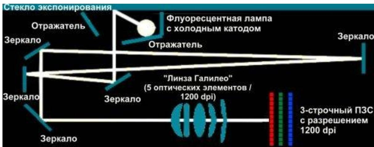
Рисунок 1 – Технология сканирования Canon с использованием линзы Галилео
