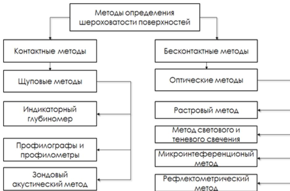
Рисунок 1 – Методы определения шероховатости поверхностей
