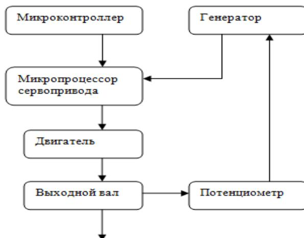
Рисунок 1 - Принцип работы сервопривода
