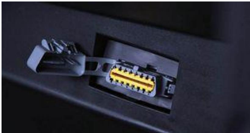
Рисунок 2 – Расположение диагностического разъема Renault Logan
