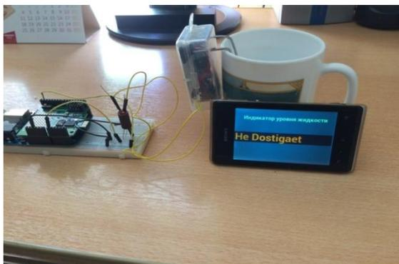
Рисунок 3 – Дистанционный датчик жидкости в начале процесса
