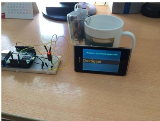
Рисунок 4 – Дистанционный датчик жидкости в конце процесса
