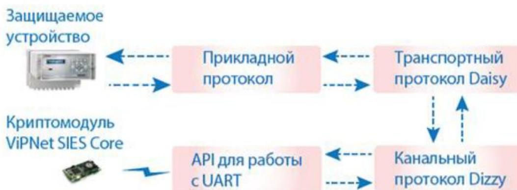
Рисунок 2 – Взаимосвязь криптомодуля с защищаемым устройством посредством протоколов
