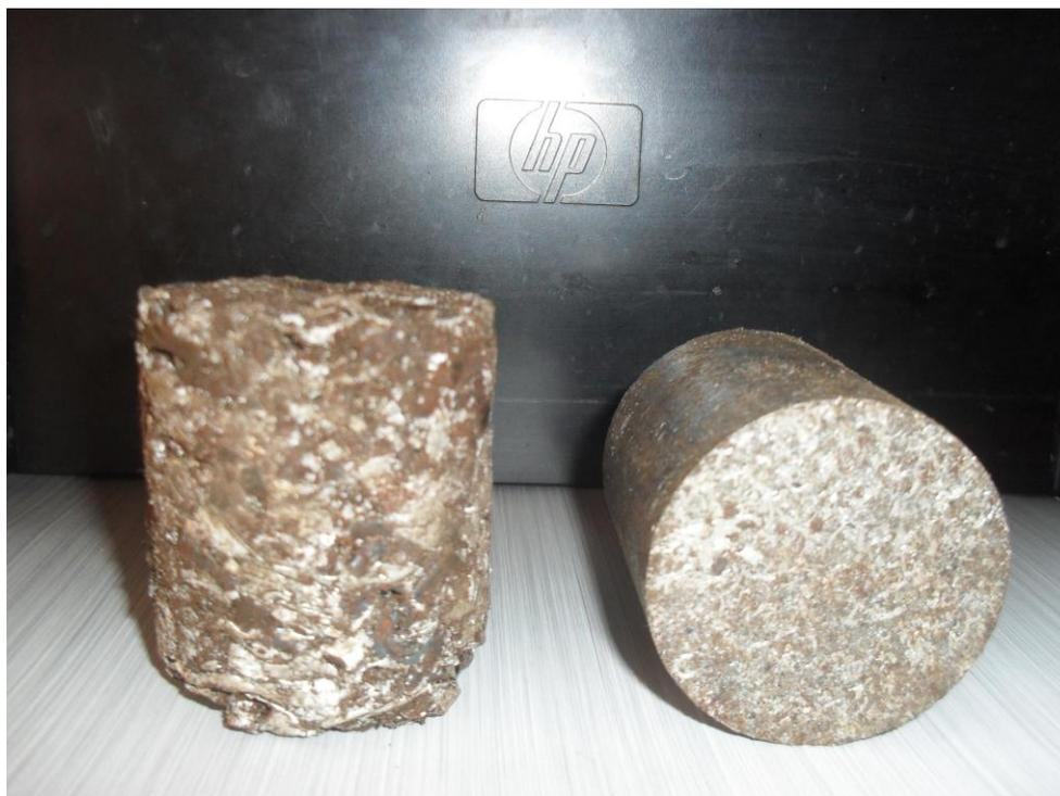
Рисунок 1 – Ферроалюминиевые брикеты (самостоятельно изготовленные на специализированном оборудовании)
