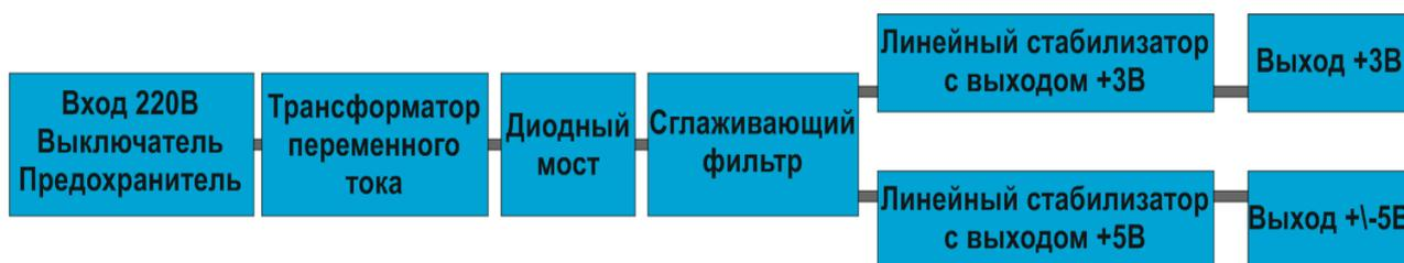
Рисунок 1 – Структурная схема устройства стабилизированного блока питания с выходами 5В и 3В
