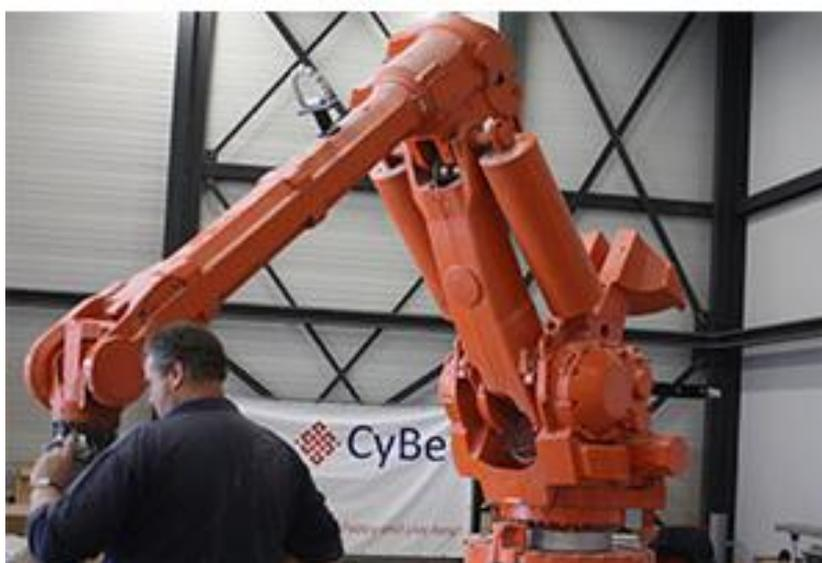
Рисунок 5 – Строительный принтер CyBe R 3D
