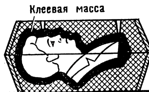
Рисунок 4 – Заливка клеевого раствора
