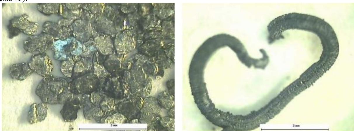
Рисунок 2 – Частицы интеркалированного графита (а) и терморасширенного графита (б)
