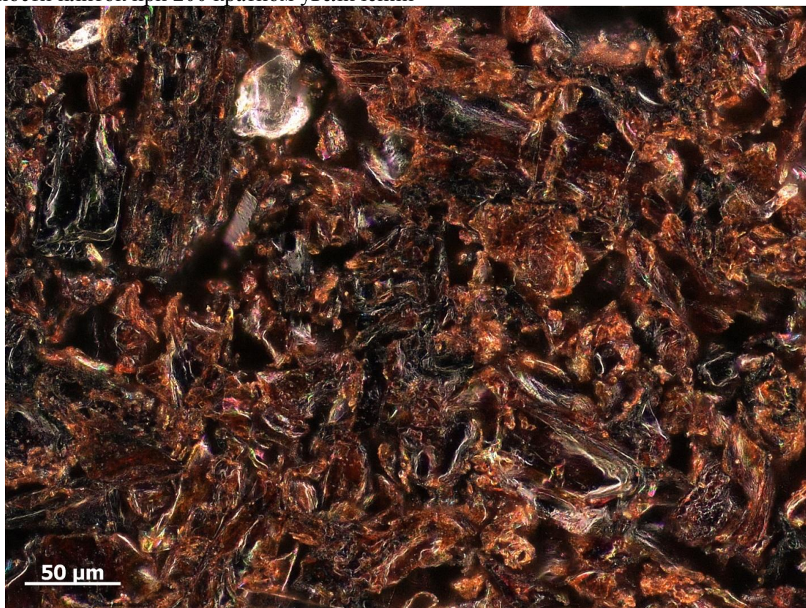
Рисунок 1 – Плитка из немодифицированной коры при 200 кратном увеличении
