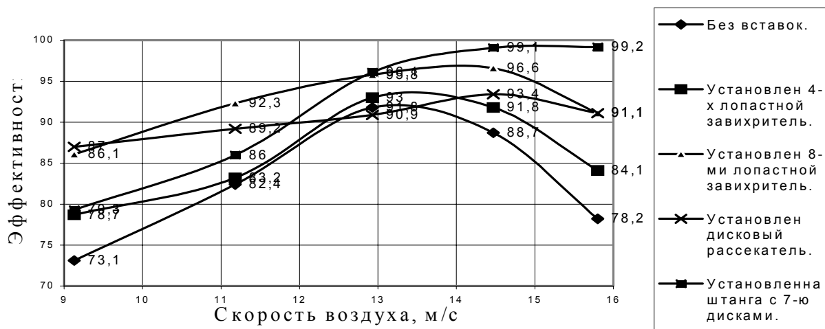
Рисунок 3 - Зависимость эффективности пылеочистки от скорости воздуха (пыль мучная)
