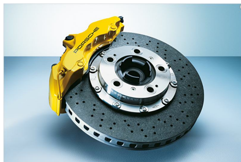
Рисунок 2 – Углепластиковый тормозной диск автомобиля Porsche Carrera GT
