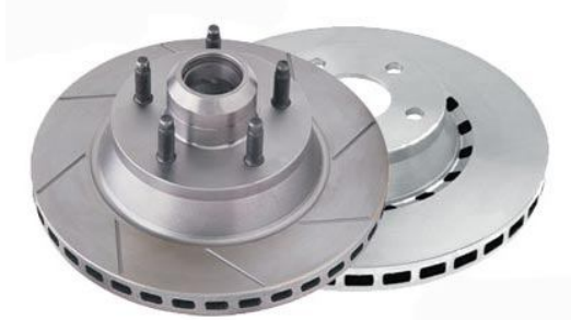
Рисунок 1 – Вентилируемый тормозной диск
