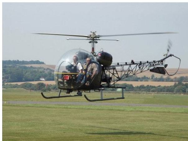
Рисунок 1 – Конструкция шасси вертолета Bell 47
