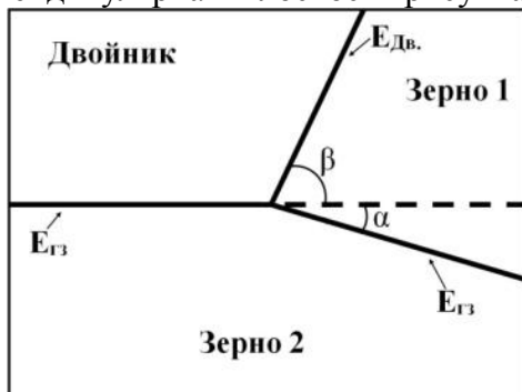
Рис. 2. Схема тройного стыка ГЗ металла Cu, содержащего двойниковую границу.
