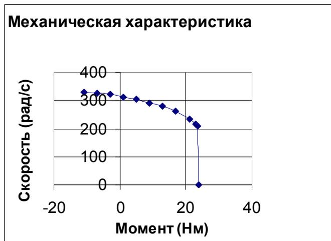
Рисунок 2 - Механическая характеристика асинхронного двигателя
