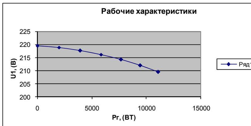
Рисунок 3б - Рабочие характеристики генератора
