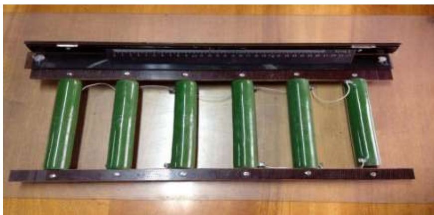
Рисунок 2 – Заземляющий резистор в сборе
