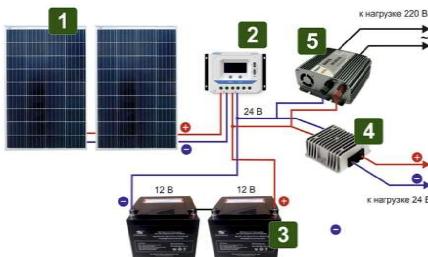
Рисунок 3 – Структурная схема системы электроснабжения пасеки на базе миниСЭС
