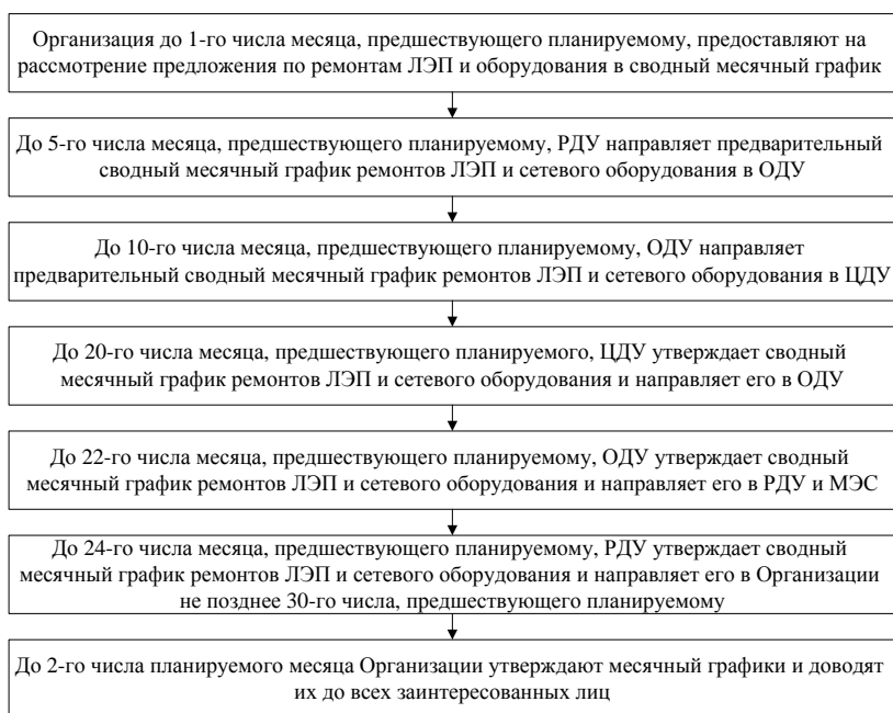
Рисунок 1 – Система месячного планирования ремонтов ЛЭП и электрооборудования
