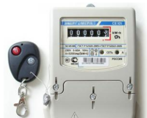
Рисунок 1 – Модифицированный счетчик с пультом для запуска или остановки учета электроэнергии
