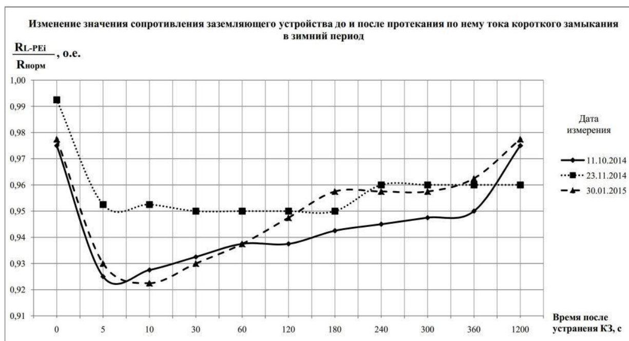
Рисунок 3 - Изменение значения сопротивления заземляющего устройства до и после протекания по нему тока короткого замыкания (в разных режимах работы) в зимний период
