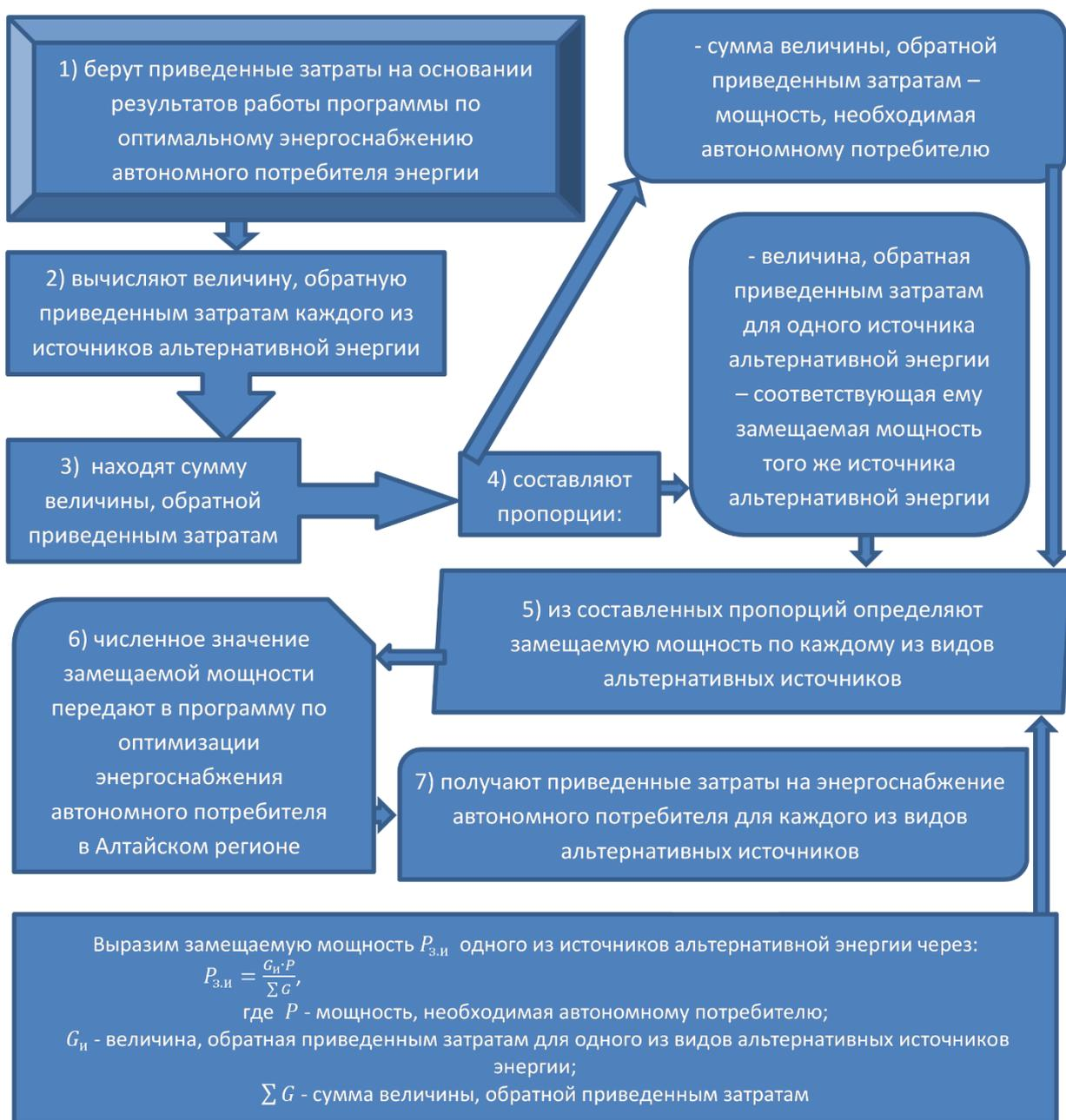
Рисунок 1 - Определение замещаемой мощности для каждого из видов альтернативных источников энергии по минимуму приведенных затрат
