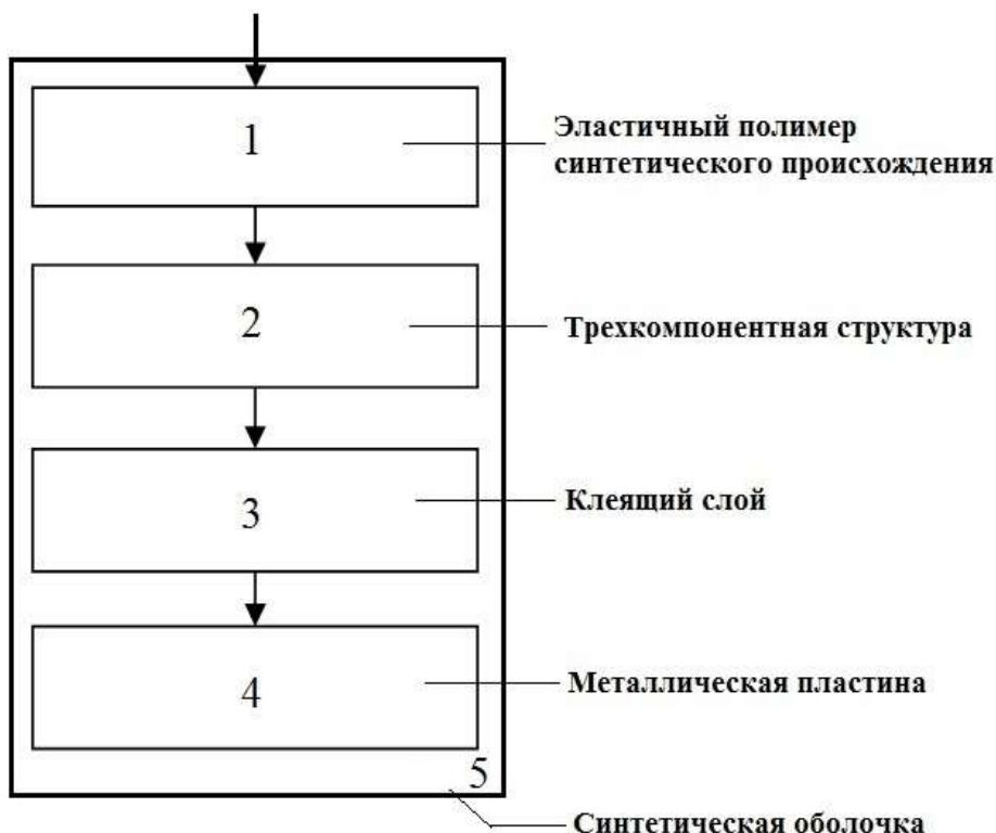
Рисунок 1 – Схема устройства для снижения опасности электромагнитных излучений
