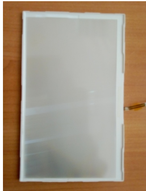
Рисунок 4 – LCD-дисплей системы проходящей подсветки
