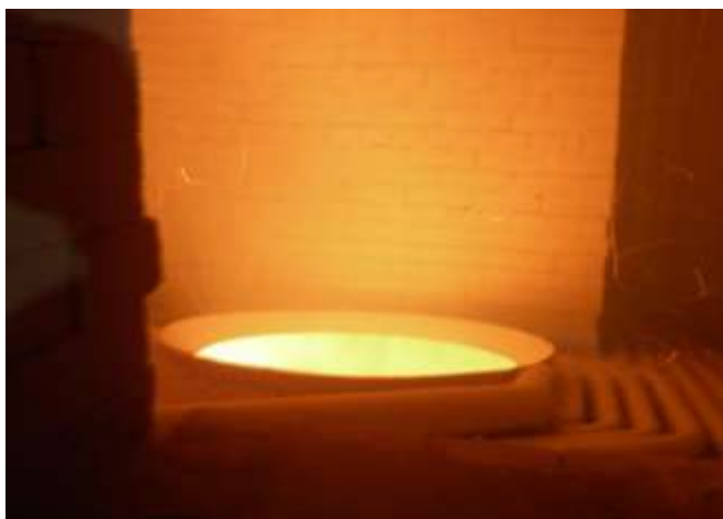
Рисунок 3 – Вид в камеру охлаждения, выход из вихревой топки.
