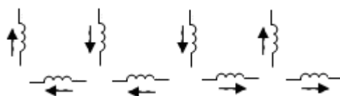
Рисунок 3 - Направления электромагнитного потока и протекающего тока по обмоткам статора электродвигателя
