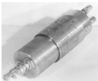
Рисунок 6 – Второй вариант выполнения ультразвуковых преобразователей прибора
