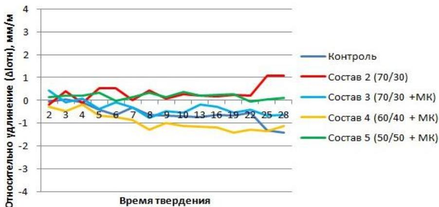
Рисунок 2 – Зависимости линейного удлинения образцов от времени твердения
