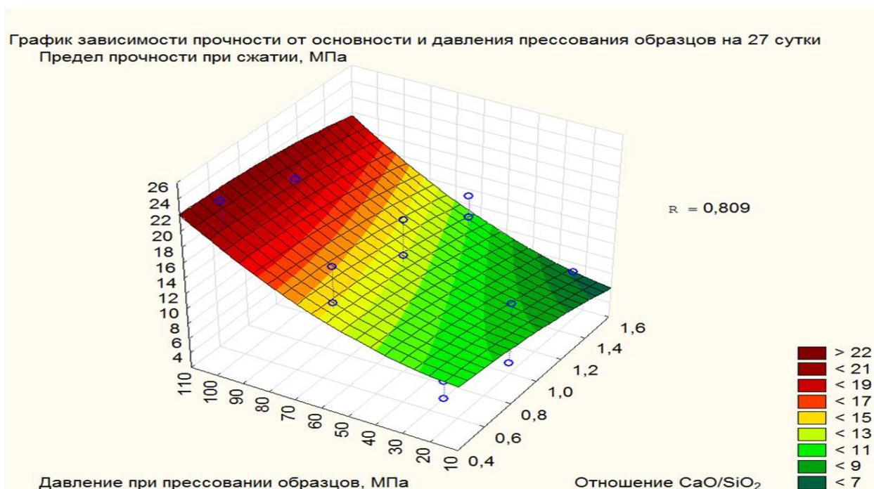
Рисунок 6 – Результаты испытания образцов с добавлением микрокремнезема на 28 сутки твердения
