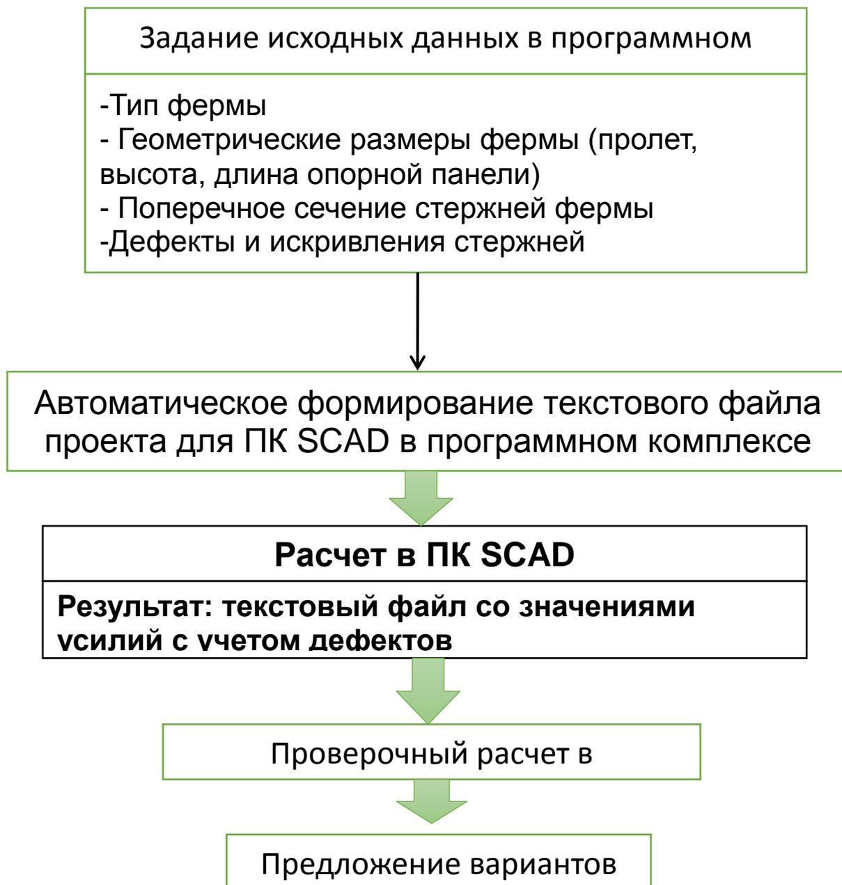
Рисунок 3. Схема взаимодействия разработанного программного комплекса с системой SCAD для автоматизированного расчета усилий с учетом дефектов
