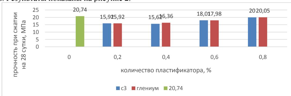
Рисунок 2 – влияние пластифицирующих добавок на прочность бетона.
