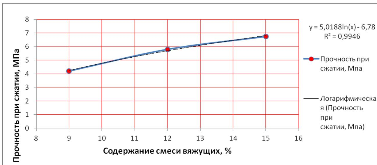
Рисунок 2 – Прочность при сжатии образцов с содержанием смеси ВКЗ+ПЦ в соотношении 2:1.
