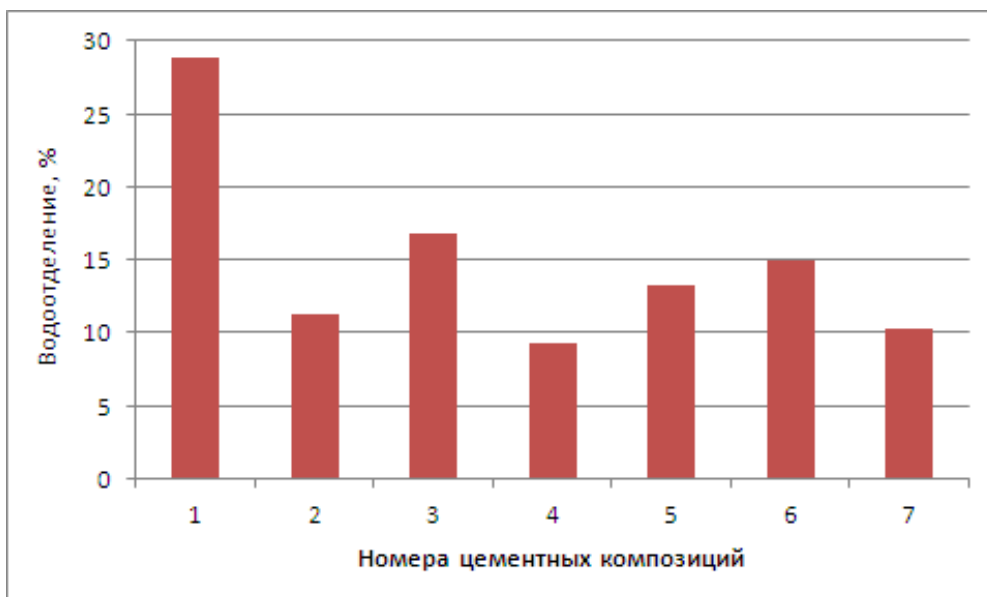
Рисунок 1 – Зависимость водоотделения от состава цемента
