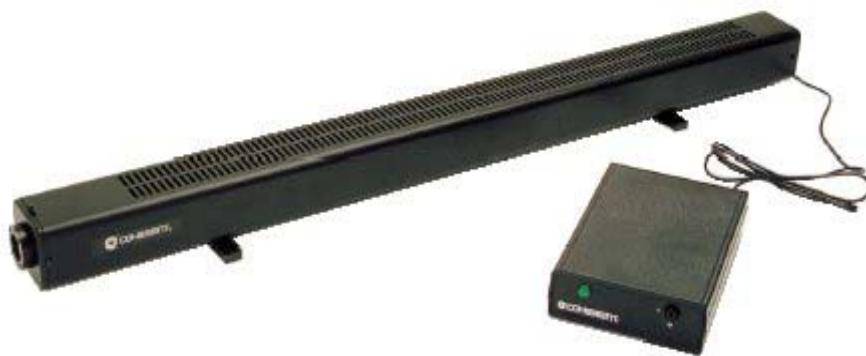
Рис.1. Лазер High Power 632.8 nm Red Helium Neon Lasers (P=35 мВт; дл. волны 632,8 нм; расходимость 0,66 ; ширина полосы 165 МГц).
