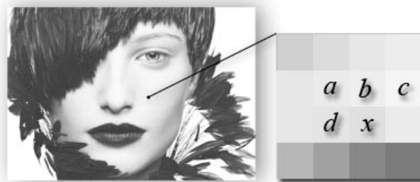
Рисунок 3 – Пространственная матрица для оценки изменения уровня интенсивности ( D ) на соседних пикселях с пикселем ( x ).
