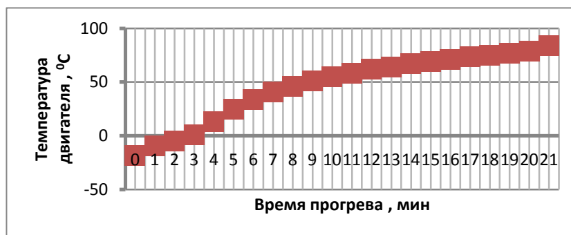
Рисунок 2- Зависимость температуры двигателя от времени прогрева График зависимости расхода топлива от времени прогрева представлен на рисунке 3.
